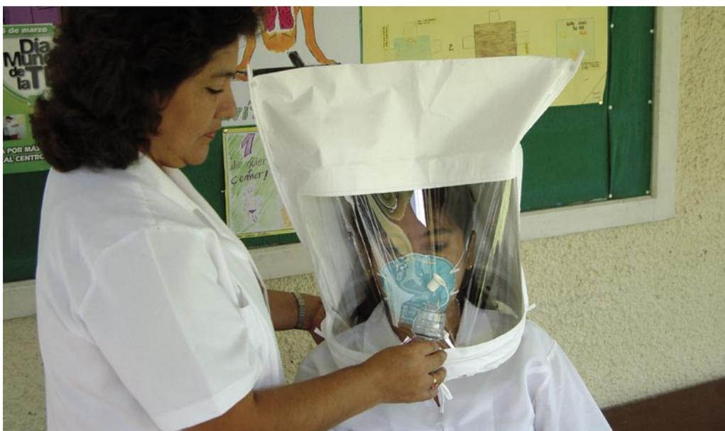
4. Para mantener una concentración adecuada de aerosol durante esta prueba, inyecte aerosol apretando el bulbo la mitad de las veces (5, 10 o 15) cada 30 segundos durante toda la prueba de ajuste.
