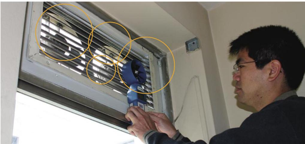
*Se usan velocímetros para medir el flujo de aire*
