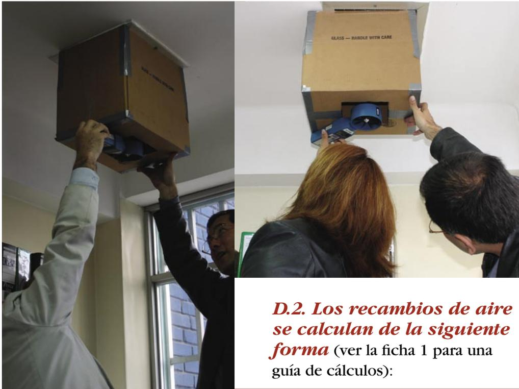
*Para medir el flujo de aire que sale de un extractor se puede usar una caja cortando una apertura*
