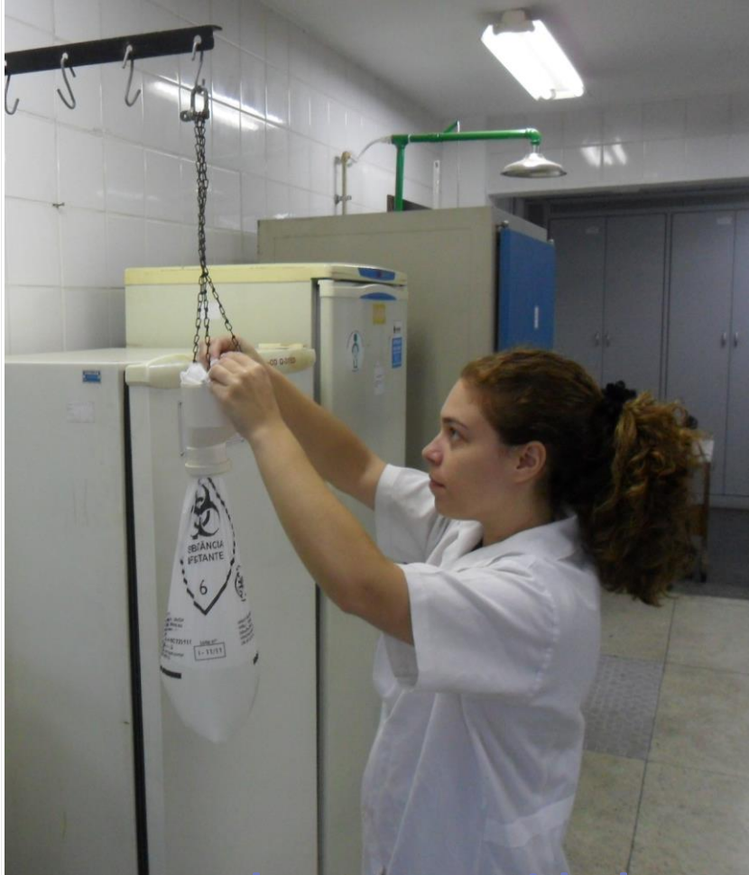
Teste de Estanqueidade
